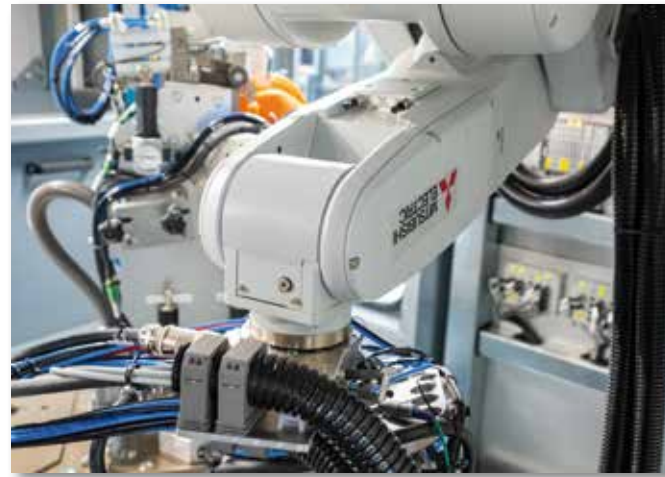
Die Melfa-Roboter müssen sich gelegentlich auch mal klein machen – eingebaut sind sie über Kopf.
